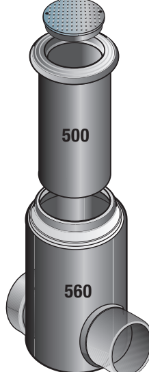
SVTK 560/500 Runko: 560 mm Teleskooppi: 500 mm Kansisto: 40 tn umpi Yhteet: < 400 mm
