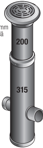
SVK 315/200 Runko: 315 mm Teleskooppi: 200 mm Kansisto: 40 tn ritilä Yhteet: < 250 mm
