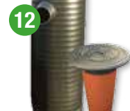
Grundvattenbrunn 400/315 mm med gjutjärnslock. Inkl. teleskop (justerbart rör) med gjutjärnslock. 2 st. 110 mm röranslutningar. Bakvattenventil till täckdike i inloppsanslutningen.
