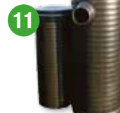
Grundvattenbrunn 400/315 mm med plastlock. Inkl. teleskop (justerbart rör) med plastlock. 2 st. 110 mm röranslutningar. Bakvattenventil till täckdike i inloppsanslutningen.
