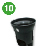
Rännbrunn, utlopp på sidan. Installeras under matningstratten. Sidoanslutning till 110 mm rör i botten.
