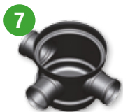
Inspektionsbrunnens botten-element 315 mm. 3 st. anslutningar med muff till 110 mm rör med tätningsspår. Används som botten i brunn gjord av 315 mm trumrör. Fästs med skruvar.
