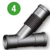
4 Justerbar förgrening 110/110/45–90° SN8. Flexibel Y-förgrening till 110 mm rör. Tätningsspår i muffen.
