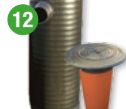
12 Perusvesikaivo 400/315 mm valurautakannella. Sis. teleskoopin (säätöputken) valurautakannella. 2 kpl 110 mm putkiyhteitä. Tuloyhteessä padotusventtiili salaojalle.
