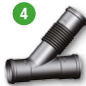
4 Säätöhaara 110/110/45-90°. Taipuisa Y-haara 110 mm putkelle. Muhveissa tiivisteurat.
