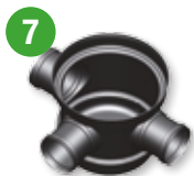
7 Tarkastuskaivon pohjaelementti 315 mm. 3 kpl muhvilisia yhteitä 110 mm putkelle, joissa tiivisteurat. Käytetään 315 mm rumpuputkesta tehdyn kaivon pohjana. Kiinnitys ruuveilla.
