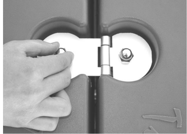
Kuva 2B. Kiinnikkeiden asennus
