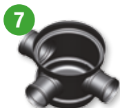
Tarkastuskaivon pohjaelementti 315 mm. Käytetään esim. 315 mm rumpuputkesta tehdyn kaivon kantana ja pohjana. Kiinnitys ruuveilla.
