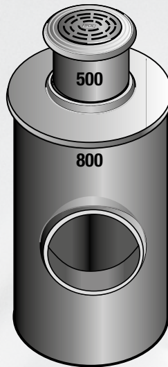
SVK 800/500 Runko: 800 mm Teleskooppi: 500 mm Kansisto: 40 tn ritilä Yhteet: < 684 mm
