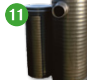
Perusvesikaivo 400/315 mm muovikannella. Sis. teleskoopin (säätöputken) muovikannella. 2 kpl 110 mm putkiyhteitä. Tuloyhteessä padotusventtiili salaojalle.
