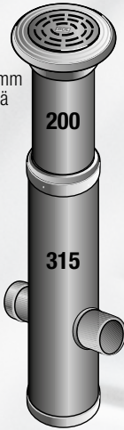
SVK 315/200 Runko: 315 mm Teleskooppi: 200 mm Kansisto: 40 tn ritilä Yhteet: < 250 mm
